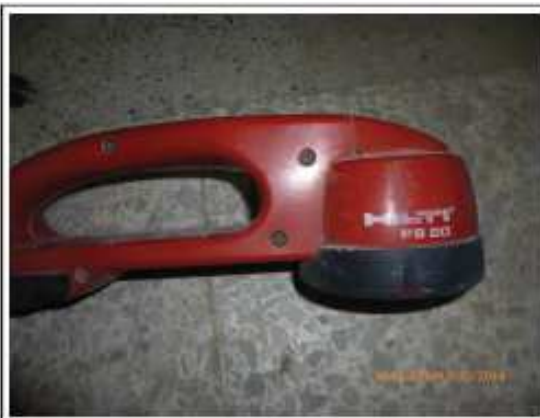
Foto 6: Ferroscan HILTI PS 20 digital para localización de barras refuerzo profundidad 30 a 40 mm
