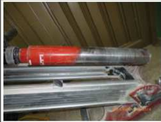
Foto 2: Broca diamantada de 2" utilizada en la extracción de núcleos en esta exploración
