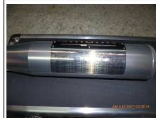
Foto 4: Resultados con una aproximación del 15% en hormigón de 1.280 a 8.500 PSI
