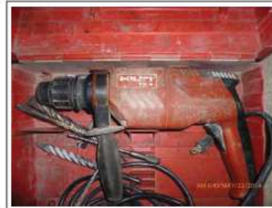
Foto 8: Taladro HILTI doble función para anclaje de soportes del extractor de núcleos.
