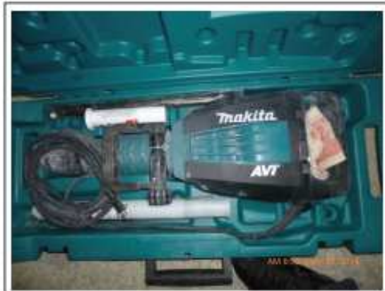
Foto 7: Taladro demolidor Makita HM1214C para regatas en columnas
